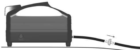
Nota: El lado de salida de la válvula de retención tiene una pequeña marca que dice "OUT" moldeada en el lado. La dirección del flujo se puede verificar fácilmente al soplar en un extremo de la válvula de retención.
