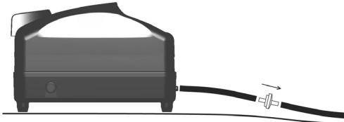
Remarque : Le côté sortie du clapet anti-retour comporte un petit « OUT » (sortie) moulé sur le côté. Il est facile de vérifier le sens de l'écoulement en soufflant dans l'extrémité du clapet anti-retour.
