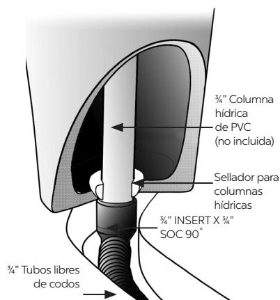
Las Bases de Fuente FB3200/FB4600 de Atlantic tienen un bolsillo empotrado que permite la instalación de fundas de conducto de  $1\frac{1}{2}$ " / 38mm dentro de la circunferencia de la fuente sin necesidad de hacer ranuras para el cable de la bomba y el cableado de bajo voltaje. Se incluye un tope de cable de  $1\frac{1}{2}$ " / 38mm para taponar la funda y de este modo impedir que ingrese grava y otros residuos al conducto.
