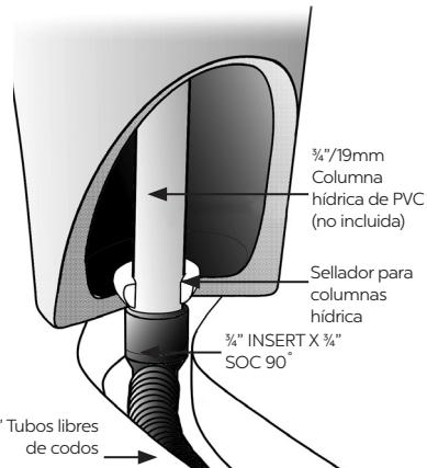
Las Base de Fuente FB3200/FB4600 de Atlantic tienen un bolsillo empotrado que permite la instalación de fundas de conducto de 1½"/38mm dentro de la circunferencia de la base sin necesidad de hacer ranuras para el cable de la bomba y el cableado de bajo voltaje. Se incluye un tope de cable de 1½"/38mm para taponar la funda y de este modo impedir que ingrese grava y otros residuos al conducto.
