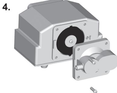
5. Después de aflojar los tornillos y quitar el disco de apoyo se puede cambiar la membrana
